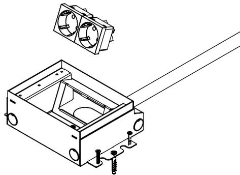
Retirez temporairement la plaque de recouvrement en acier et poussez le nombre nécessaire de ports de sortie pour connecter les prises de courant (3).
