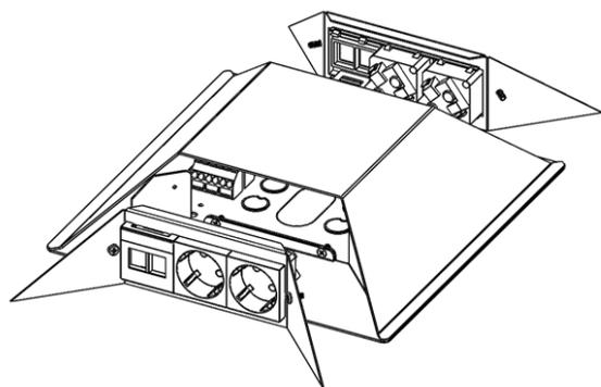
Placez les modules d'insertion (230V/ données fournis séparément) dans le panneau encastrable (1). Connectez le câblage.
