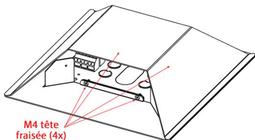
Placez le capot de transfert Bunker (2) sur la plaque de montage et fixez-le avec les vis fournies.
