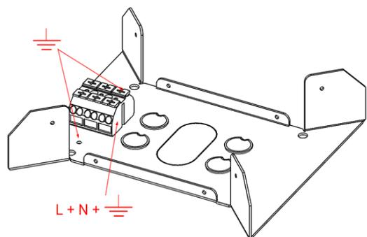
Passez le câblage par le bas en utilisant les ports de sortie dans le fond. Connectez les câbles au bornier de connexion. Fournissez la mise à terre de l'intérieur sur l'un des trous de 3,5 mm (à l'aide d'une vis M4 taptite).
