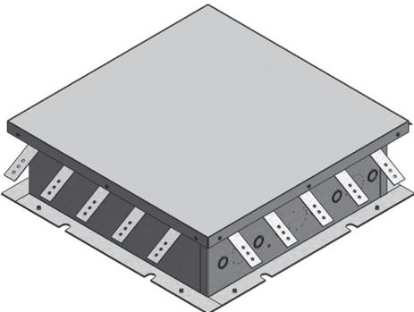
L'intérieur du couvercle de la Multibox doit être rempli avant le coulage avec une plaque de recouvrement temporaire (non fournie) ou avec les couvercles intérieurs définitifs\*.
