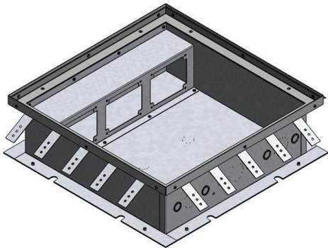
Placez-la dans la bonne position et réglez la Multibox à la hauteur correcte, de façon à ce que le dessus du bord du couvercle soit aligné avec la finition finale du sol.
